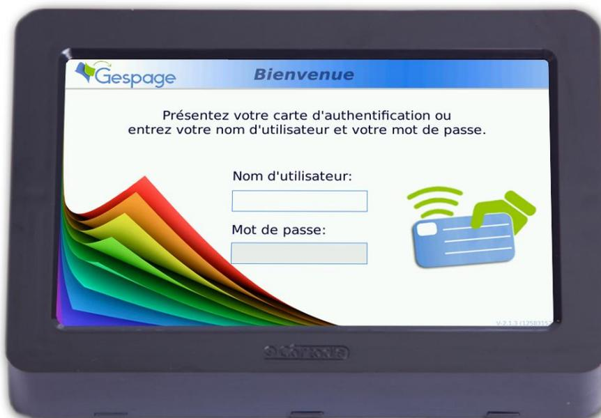
Le **cPad** est un terminal réseau externe, équipé d'un écran tactile, qui permet de libérer les travaux d'impressions à partir de n'importe quel périphérique. Les copies, impressions et scans sont comptabilisés et remontés vers
