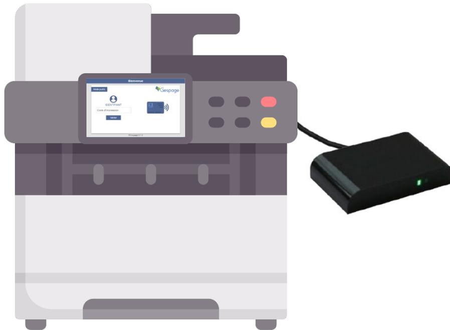
De petite taille et d'un design distingué, le lecteur **Cartadis TCM3** est un lecteur de cartes sans contact RFID. Ce lecteur est monofréquence et optimisé pour une gestion des technologies Radio Mifare 13.56 MHz ou 125kHz. Ils émulent par défaut un clavier USB et ne nécessitent donc pas l'installation de pilote sur les PC Windows.
